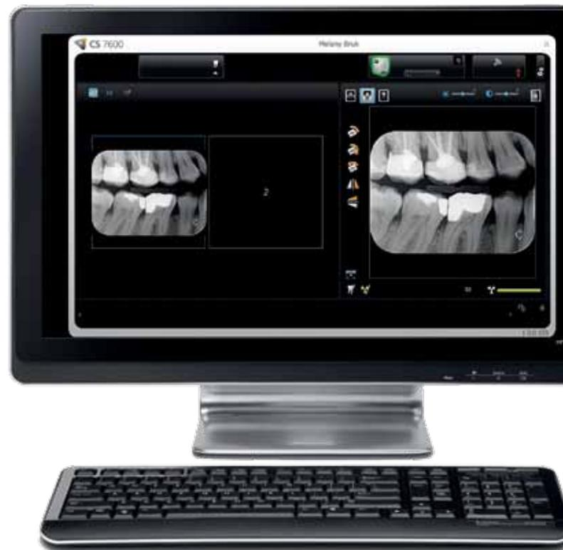
Les images du patient sont capturées à partir de la plaque identifiée et numérisé grâce au dispositif «Scan & Go» du système CS 7600.
